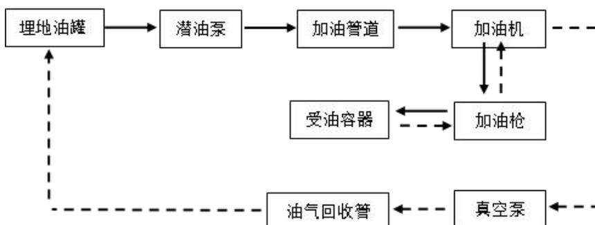
注：虚线箭头表示油气回收工艺路线。
