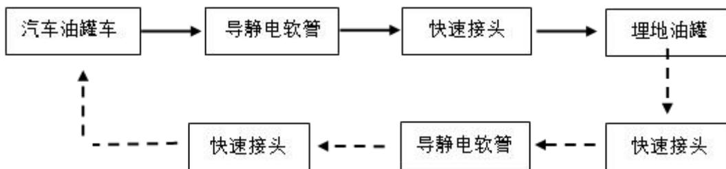
注：虚线箭头表示油气回收工艺路线。
