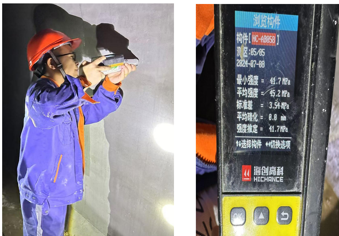
图 2-25 混凝土实体回弹检测
