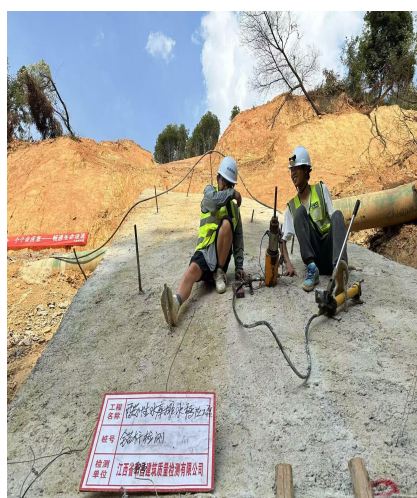
图 2-11 斜槽段基础锚杆抗拔检测
