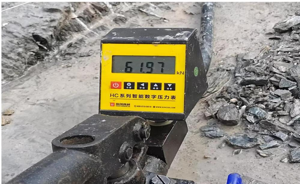
图 2.4.4-9 枫 3#副坝锚杆抗拔检测
