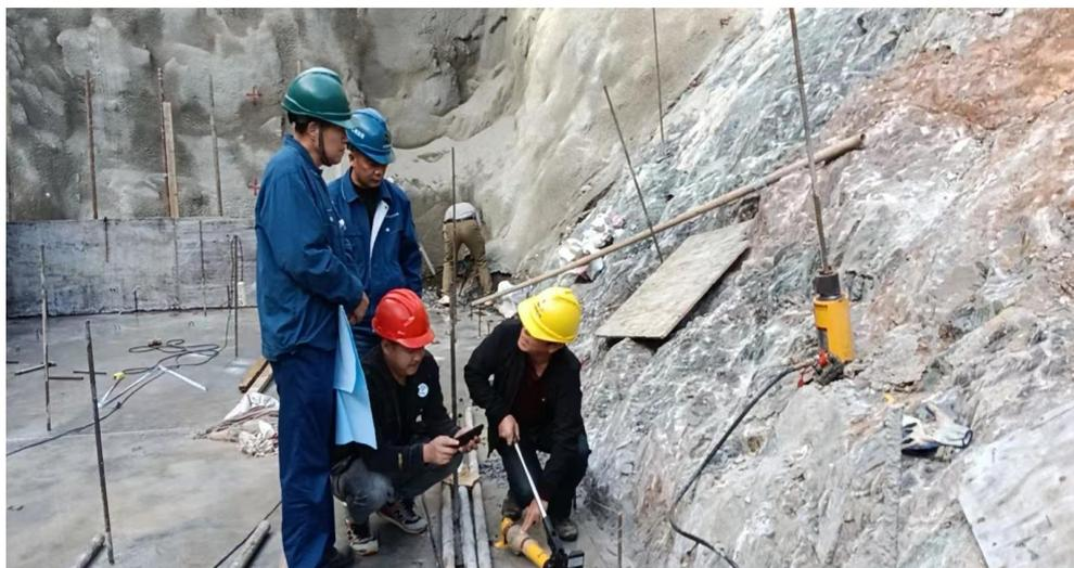
图 2.4.4-8 枫 3#副坝锚杆抗拔检测
