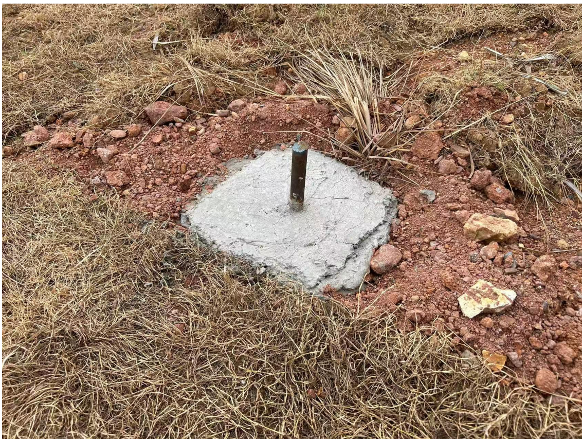
图 2-3 采场位移观测桩照片
